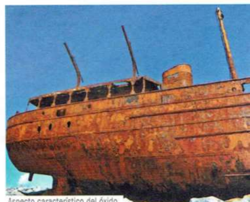
Aspecto característico del óxido que se forma en el hierro.
