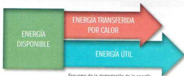
Esquema de la degradación de la energía como calor durante una transformación.
