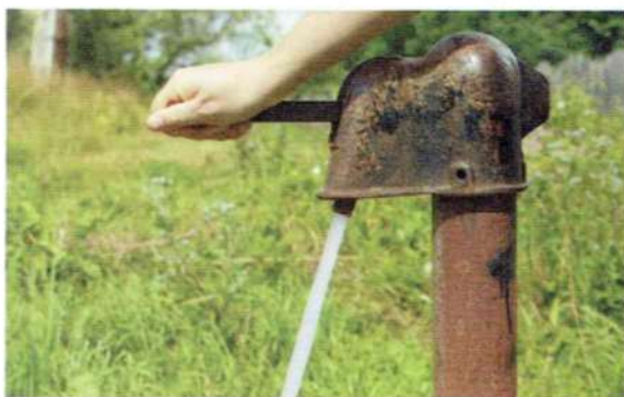
Una bomba de accionamiento manual, utilizada para sacar agua de la napa.
