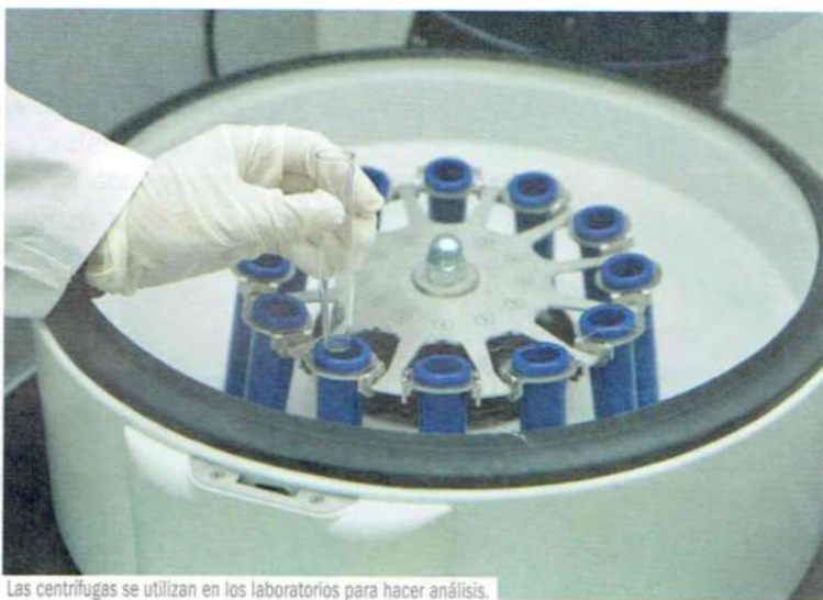
Las centrífugas se utilizan en los laboratorios para hacer análisis.
