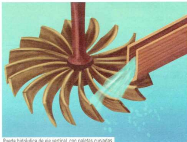
Rueda hidráulica de eje vertical, con paletas curvas.
