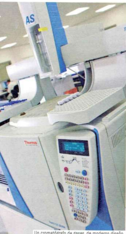
Un cromatógrafo de gases, de moderno diseño.
