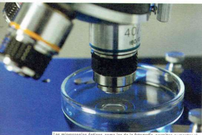
Los microscopios ópticos, como los de la fotografía, permiten aumentar el tamaño de una muestra hasta mil veces su tamaño con respecto a la visión humana, mientras que los electrónicos, gracias a los avances tecnológicos, pueden hacerlo hasta 200 mil veces.
