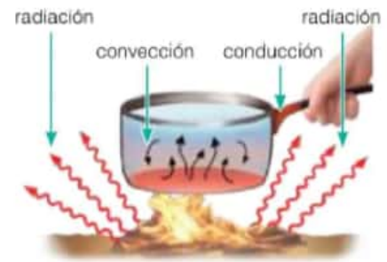
Los tres mecanismos de intercambio del calor.
