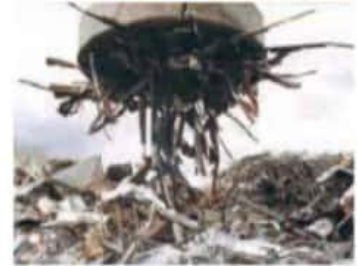
Esta máquina posee un electroimán en la punta de la pinza, que se utiliza para atraer todos los residuos metálicos de la basura, para luego reciclarlos.
