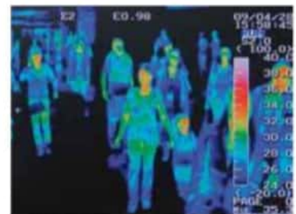
La radiación térmica se emite por el solo hecho de poseer temperatura. Son ondas electromagnéticas, no hay transporte de materia.
