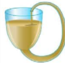
El frasco de Boyle, un intento de móvil perpetuo.
