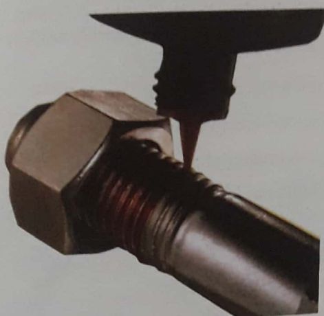
Figura 10.26. Aplicación de un producto fijador de roscas.
