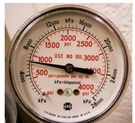
Manómetro aneroide de doble escala: en kPa (kilopascuales) y en psi (pounds per square inch).
