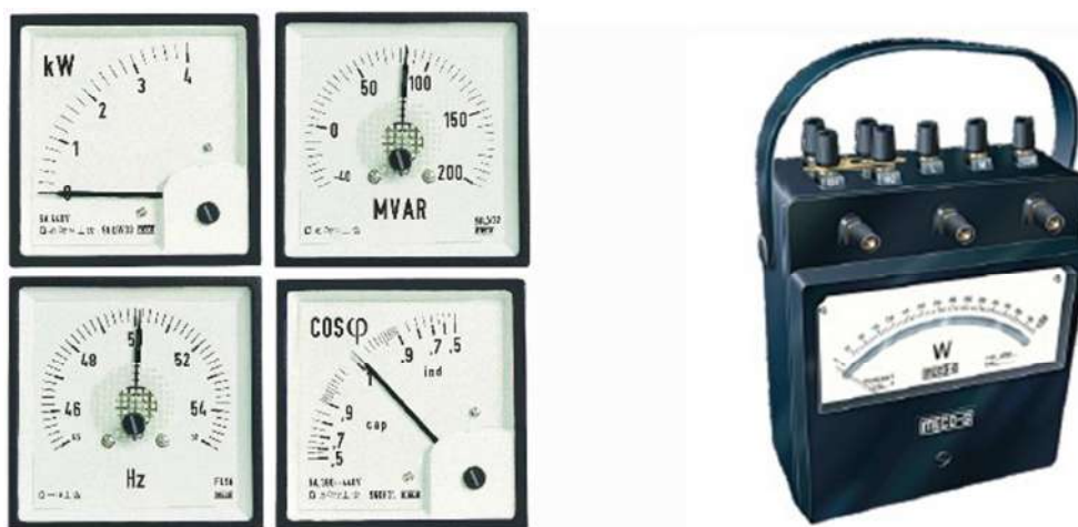
Figura 12: Instrumentos de medida de montaje fijo (izquierda) y portables (derecha)
