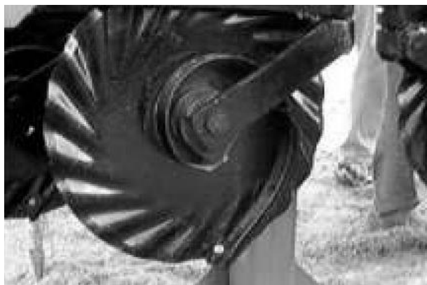
FIGURA 77. APRETARASTROYO ADHERIDO A LA CUCHILLA CORTADORA.
