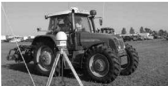
FIGURA 72. ANTENA DE DETECCIÓN DE LA SEÑAL GPS.
