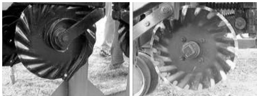
FIGURA 76. CUCHILLAS DEL TIPO TURBO QUE MEJORAN EL CORTE Y LA MICROLABRANZA.
