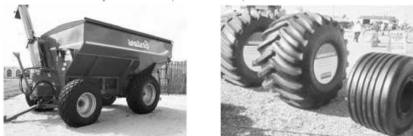
Figura 37. Neumáticos de alta flotación para evitar huellas y compactación.
