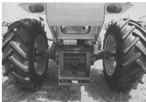
FIGURA 10. VISTA DE TOMA DE POTENCIA DEL MOTOR
