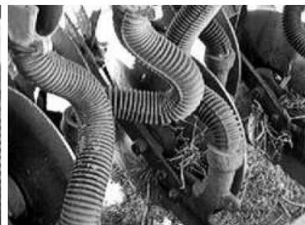
Figura 68. Caños de bajada con pliegues que afectan la uniformidad de descarga de semillas.
