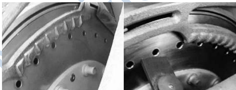
Figura 53. Enrasador de serrucho utilizado en dosificadores neumáticos.
