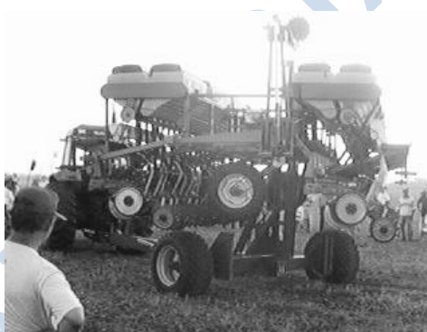
Figura 100. Sistema de transporte central con elevación y disposición de la sembradora sobre el chasis de la misma.
