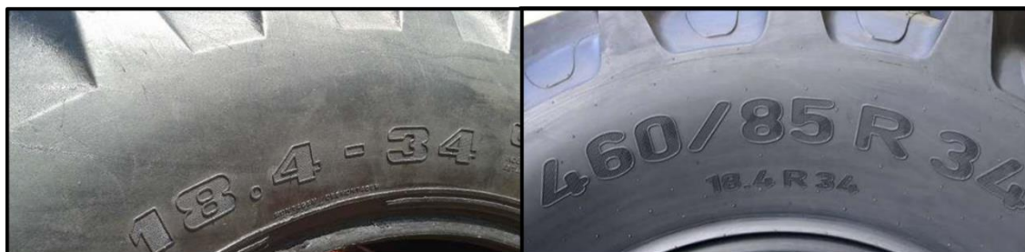
Figura 27. Nomenclatura de un neumático diagonal (izquierda) y un radial (derecha).
