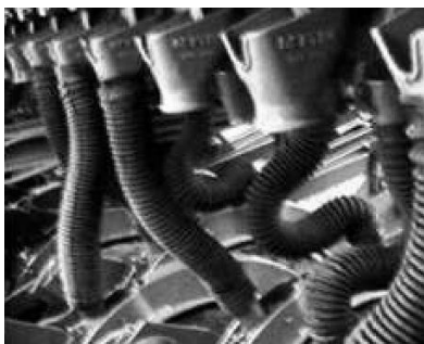
Figura 68. Caños de bajada con pliegues que afectan la uniformidad de descarga de semillas.
