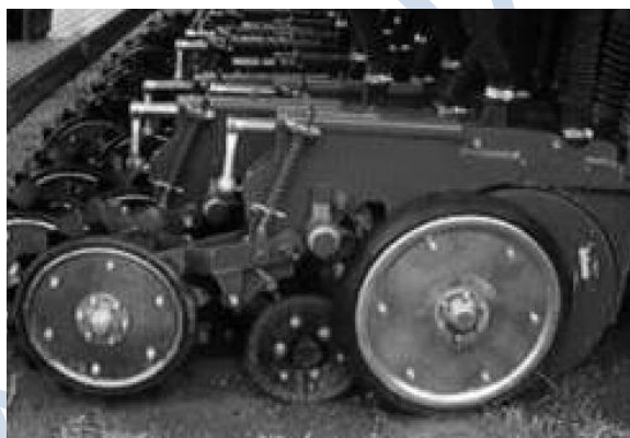
FIGURA 94. RUEDAS TAPADORAS CON FIJACIÓN AL CHASIS Y RESORTES DE CARGA INDIVIDUAL.
