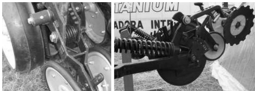
FIGURA 93. DETALLE DE LA FIJACIÓN INTEGRADA DE LAS RUEDAS TAPADORAS.
