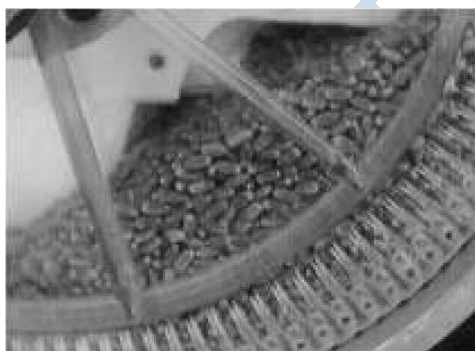
Figura 61. Placa de sujeción por presión construida en policarbonato transparente. Enrasador de cepillo.
