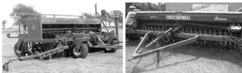
FIGURA 32. SISTEMA MONOTOLVA PARA DEPÓSITO DE SEMILLAS.
