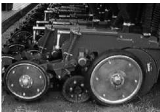
FIGURA 88. RUEDAS TAPADORAS CON FIJACIÓN AL CHASIS Y RESORTES DE CARGA INDIVIDUAL.
