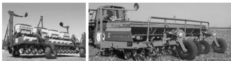
FIGURA 39. SEMBRADORA DE GRANO GRUESO.
