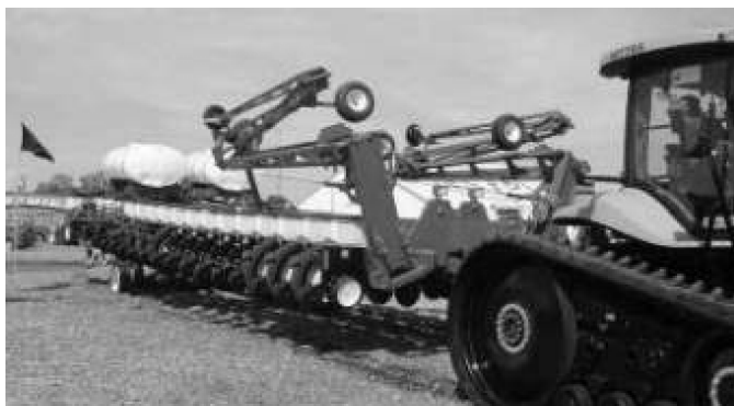
FIGURA 94. SISTEMA DE PLEGADO TIPO LIBRO PARA TRANSPORTE.
