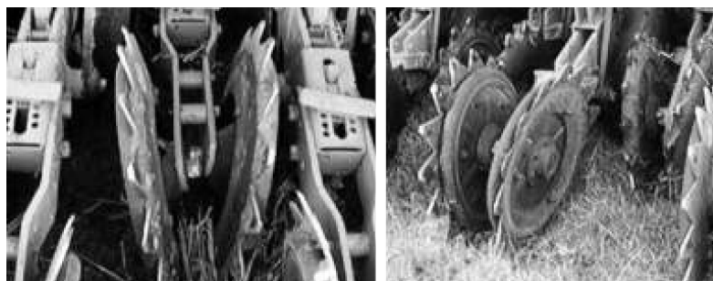
FIGURA 82. RUEDAS TAPADORAS DENTADAS.
