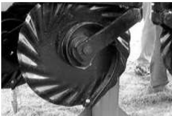
FIGURA 71. APRETARASTROJO ADHERIDO A LA CUCHILLA CORTADORA.
