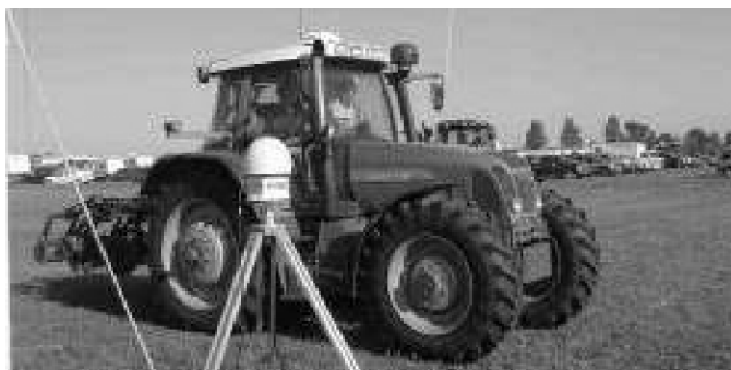
FIGURA 100. SISTEMA DE AUTOGUÍA – PILOTO AUTOMÁTICO MÁS BASE ESTACIONARIA.
