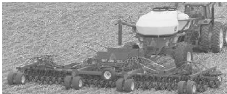
FIGURA 101. SEMBRADORA AIR DRILL DE GRAN ANCHO DE LABOR.
