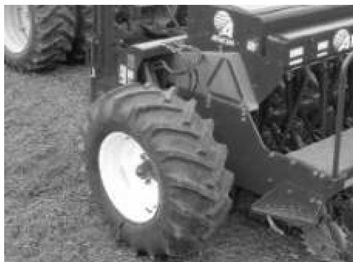
FIGURA 92. RUEDA MOTRIZ – DISPOSICIÓN Y TRANSMISIÓN.
