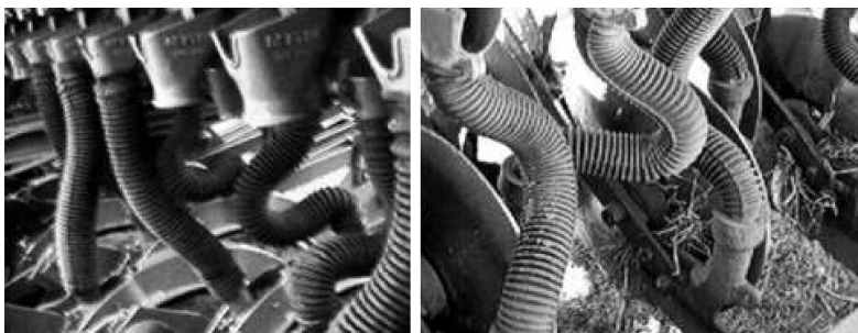
FIGURA 62. CAÑOS DE BAJADA CON PLIEGUES QUE AFECTAN LA UNIFORMIDAD DE DESCARGA DE SEMILLAS.
