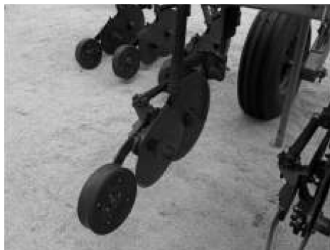
FIGURA 85. RUEDAS SIMPLES CON BANDA DEFORMABLE.
