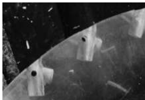
FIGURA 56. DETALLE DE LA POSICIÓN DE LA SEMILLA EN LA CAVIDAD DE LA PLACA DE PRESIÓN.
