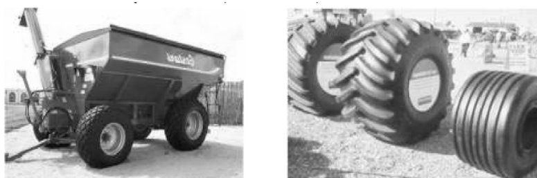
FIGURA 31. NEUMÁTICOS DE ALTA FLOTACIÓN PARA EVITAR HUELLAS Y COMPACTACIÓN.
