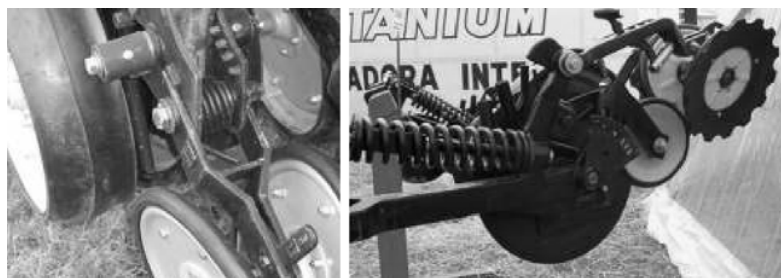
FIGURA 87. DETALLE DE LA FIJACIÓN INTEGRADA DE LAS RUEDAS TAPADORAS.
