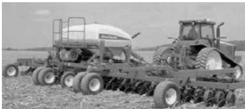
FIGURA 102. SEMBRADORA CON TOLVA DE SEMILLA CENTRAL, DOSIFICACIÓN POR RODILLO Y TRASLADO POR AIRE.
