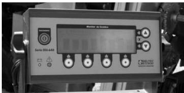
FIGURA 65. MONITOR DE SIEMBRA. VISOR DIGITAL.
