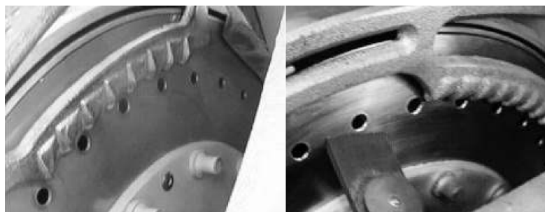
FIGURA 47. ENRASADOR DE SERRUCHO UTILIZADO EN DOSIFICADORES NEUMÁTICOS.
