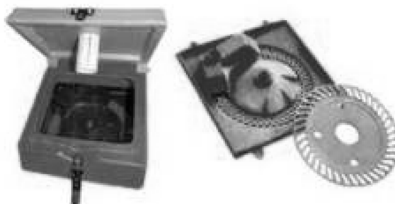
FIGURA 40. DOSIFICADOR MECÁNICO DE PLATOS CON ALVÉOLOS.
