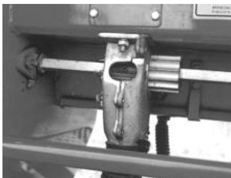
FIGURA 36. DOSIFICADOR DE RODILLO ACANALADO HORIZONTAL.
