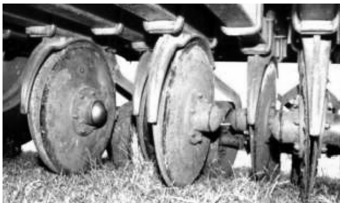
FIGURA 72. ABRESURCO BIDISCO CON DISCOS IGUALES.
