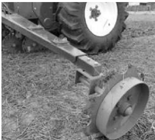
FIGURA 91. SISTEMA MARCADOR DE SIEMBRA DE BRAZO Y CASQUETE.
