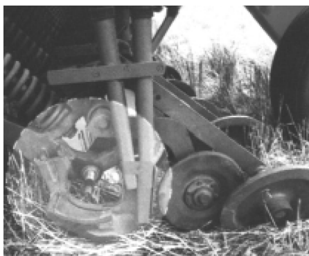
FIGURA 89. ABRESURCO BIDISCO CON ALIMENTACIÓN DE DOS LÍNEAS CONTIGUAS.
