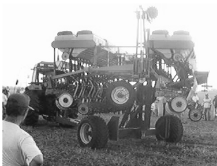
FIGURA 105. SISTEMA DE TRANSPORTE CENTRAL CON ELEVACIÓN Y DISPOSICIÓN DE LA SEMBRADORA SOBRE EL CHASIS DE LA MISMA.
