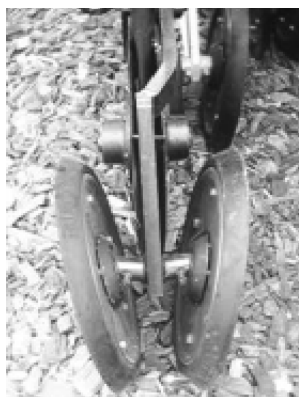
FIGURA 76. RUEDAS TAPADORAS DOBLES.
