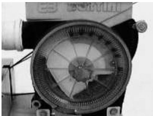
FIGURA 54. DOSIFICADOR NEUMÁTICO POR PRESIÓN.
