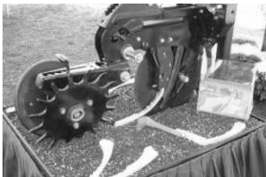
FIGURA 96. APLICACIÓN DE FERTILIZANTE LÍQUIDO CON MANGUERAS ADHERIDAS A LAS COLITAS CONTACTADORAS DE SEMILLAS.
