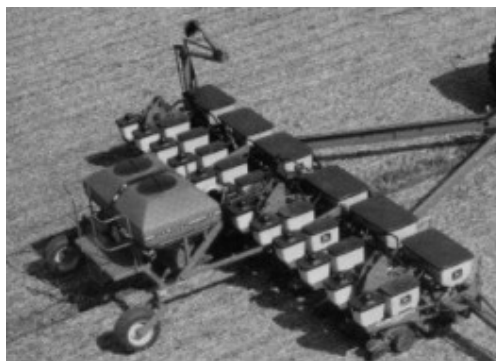
GRÁFICO 1. UNIDAD TANQUE ABASTECIENDO CON FERTILIZANTES A UNA SEMBRADORA DE GRANOS GRUESOS
