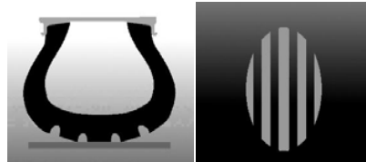
FIGURA 16 ESQUEMA HUELLA Y PISADA DE NEUMÁTICO CONVENCIONAL
