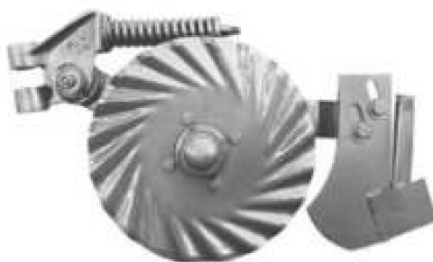
FIGURA 90. CUCHILLA CORTADORA CON ZAPATA DE FERTILIZACIÓN.
