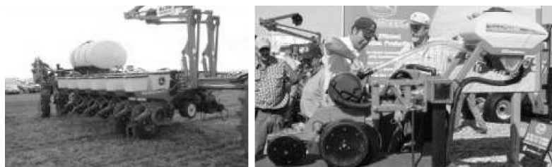
FIGURA 95. SISTEMA DE TOLVA GENERAL CON ALIMENTACIÓN DE TOLVAS INDIVIDUALES POR MEDIO DE CORRIENTE DE AIRE.
