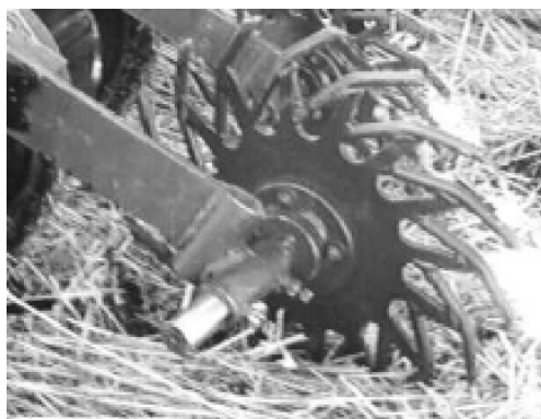
FIGURA 78. BARRERASTROJO DE ALAMBRE.
