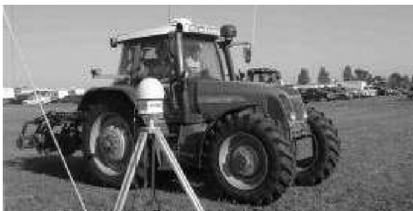
FIGURA 66. ANTENA DE DETECCIÓN DE LA SEÑAL GPS.
