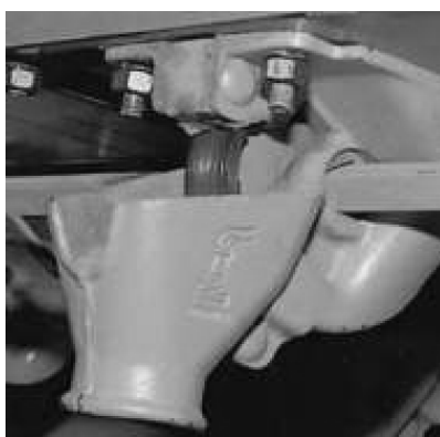
FIGURA 34. DOSIFICADOR DE ROLDANA.
