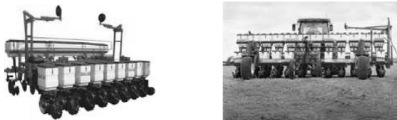
FIGURA 33. SISTEMA DE TOLVAS INDIVIDUALES PARA DEPÓSITO DE SEMILLAS.
