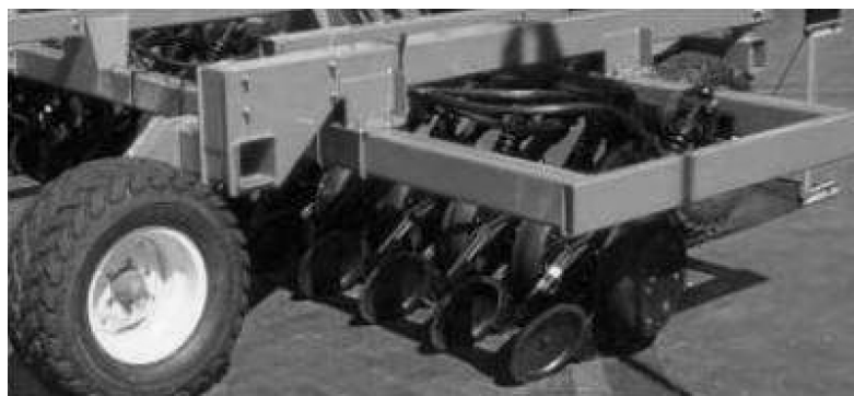
FIGURA 104. SEMBRADORA CON CUERPOS DE SIEMBRA CONSTRUIDOS EN FUNDICIÓN DE ACERO.
