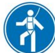
Protección obligatoria individual contra caídas
