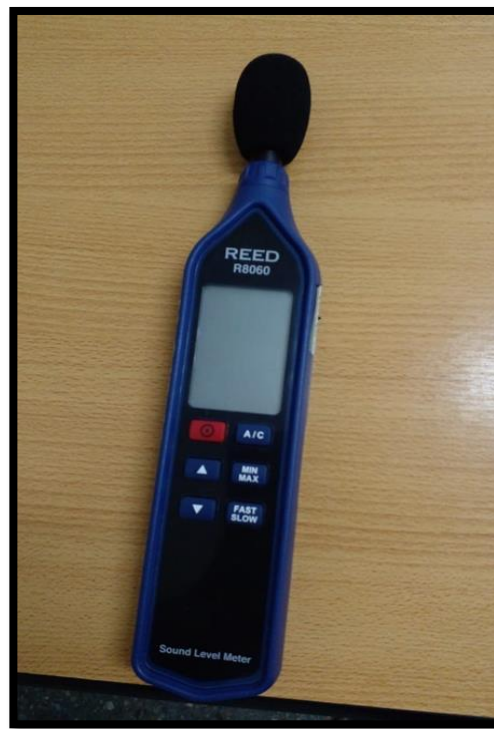
Figura 4: Decibelímetro o sonómetro: instrumento para medir niveles de ruidos.
