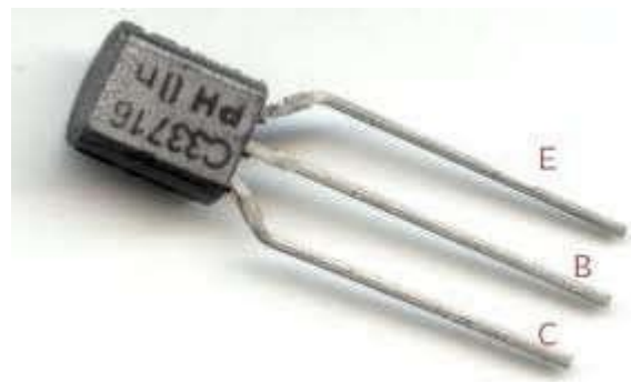
Fig. 6.46. Distribución de los terminales del transistor BC337
