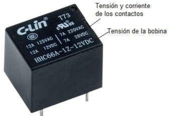
Fig. 4.25. Valores de tensión y corriente de un relé
