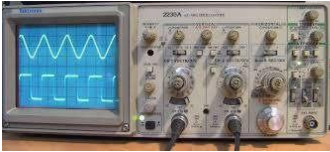
Fig. 5.5. Un osciloscopio mostrando formas de onda en su pantalla
