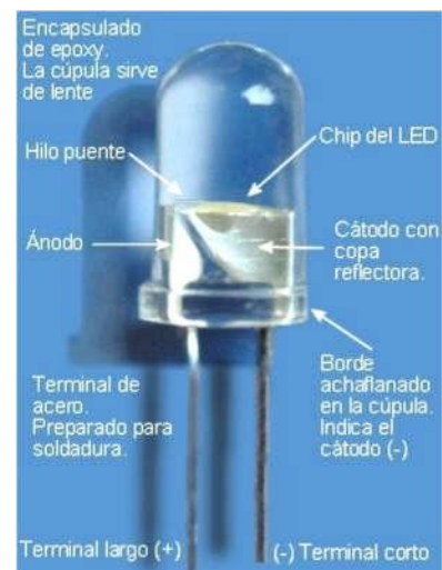
Fig. 6.39. Partes de un LED
