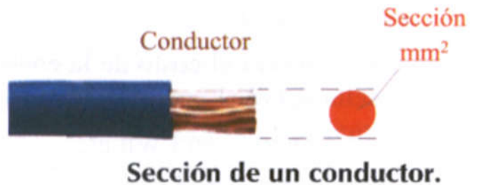
Fig. 3.13. Sección de un conductor
