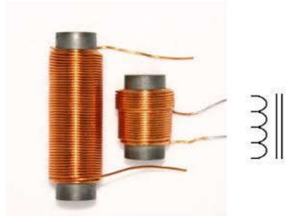
Fig. 4.47. Inductores con núcleo de hierro y su símbolo
