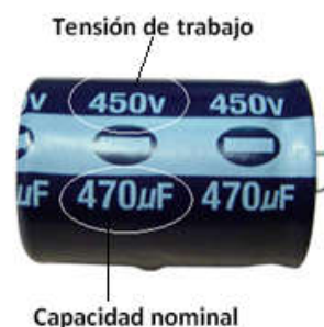
Fig. 6.17. Capacidad nominal y tensión de trabajo.
