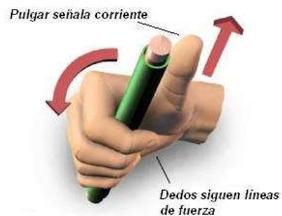
Fig. 4.16. Regla de la mano derecha para determinar la dirección del campo magnético en un conductor.
