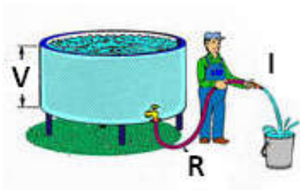
Fig. 1.19. Analogía con un sistema hidráulico
