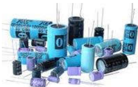
Fig. 6.21. Capacitores electrolíticos de distintos tamaños
