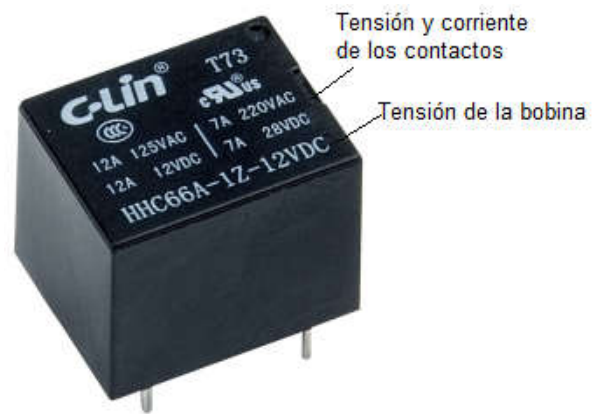
Fig. 4.25. Valores de tensión y corriente de un relé
