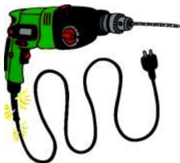
Uniones defectuosas sin aislación.
