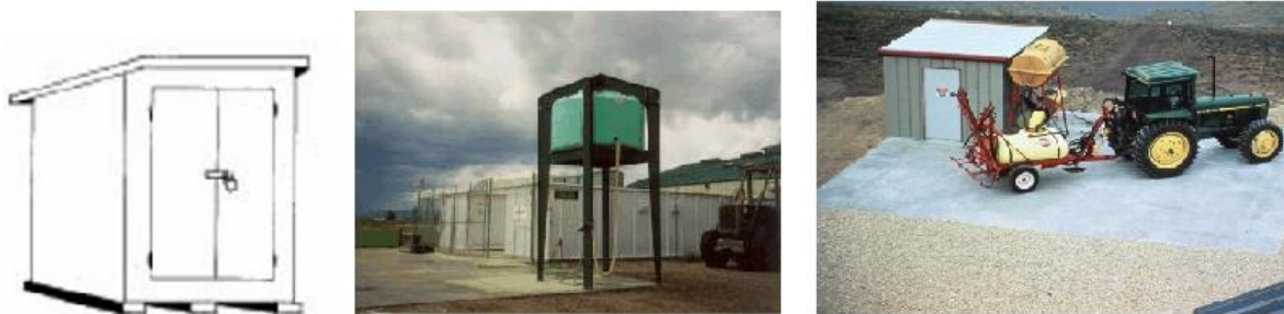
Figura 1: Alternativas de depósito para pequeñas cantidades: Cabina individual, cabinas con provisión de agua y cabina con playa de carga
