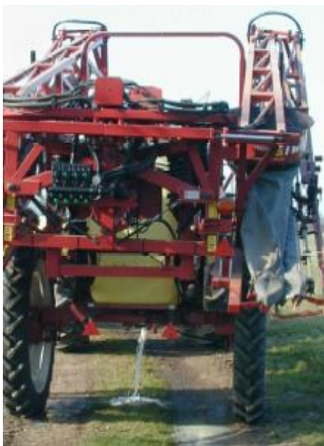
Figura N°4: Incorrecta eliminación de los sobrantes de aplicación.
