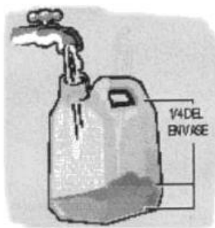
Primer paso: llenar el envase vacío con agua limpia, con una cuarta parte de su volumen total.
