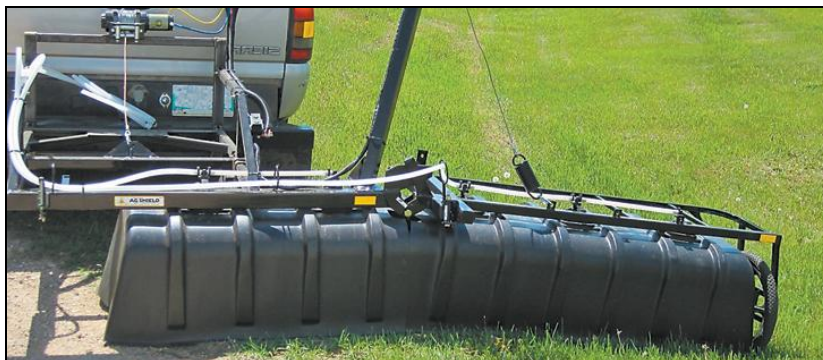
Figura N° 6: Botalón con escudo antideriva. Fuente: The Western Producer.
