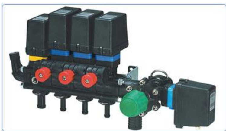
Figura Nº 36: “Manifold” eléctrico, con retornos proporcionales, cierre general, válvula reguladora de presión y válvula aliviadora de presión manual (“canilla” verde). ARAG
