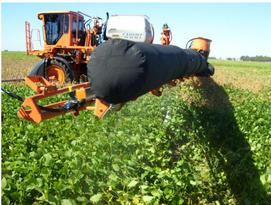
Figura N° 52: Apertura del follaje mediante túnel de viento (mejor penetración).
