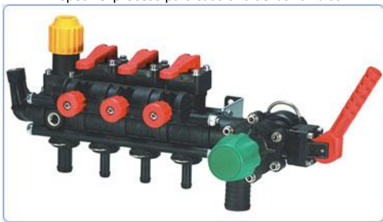
Figura 35 “Manifold” manual, con retornos proporcionales, cierre general, válvula reguladora de presión y válvula aliviadora de presión (“canilla” verde). ARAG.
