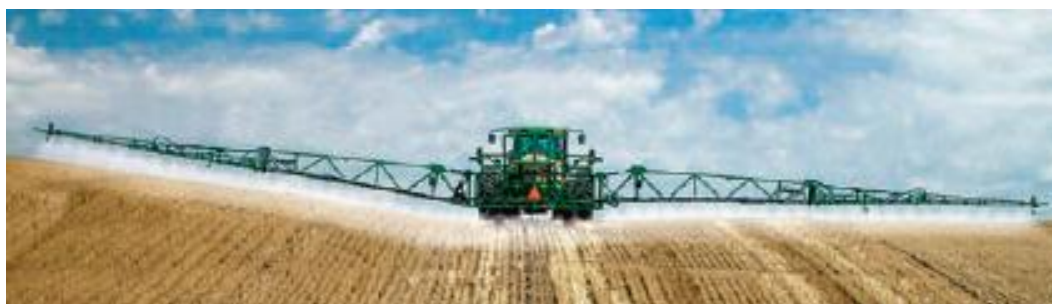
Figura Nº 47: Botalón “copiando” un terreno con pendiente variable
