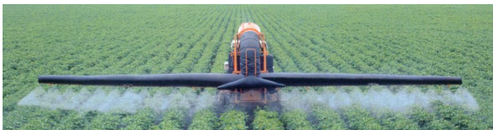
Figura 53: Control de deriva con el túnel de viento. Fuente Jacto
