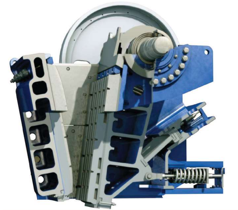
Figura N° 5. Corte Trituradora tipo Dalton.
