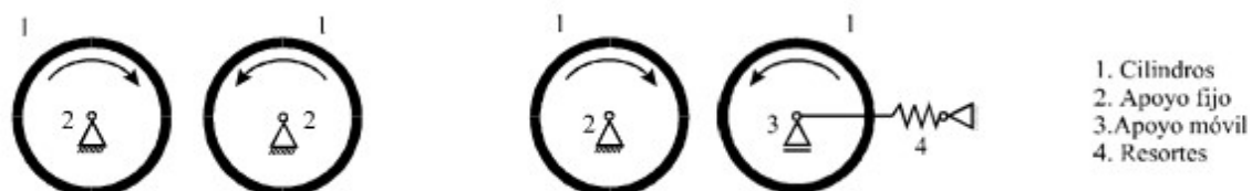
Figura N°13. Esquemas Trituradoras de cilindros
