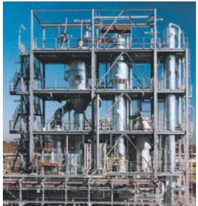
Planta de evaporación de doble efecto: circulación forzada y película descendente en contracorriente, para aguas residuales con alto contenido en sales. Unidad de destilación para el tratamiento del condensado de vahos. Caudal de evaporación: 9.000 kg/h, concentrado al 65% S.S.
