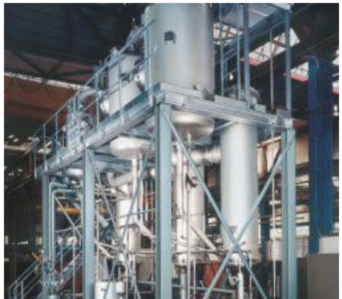
Evaporador de tres efectos de circulación forzada para glicerina. Capacidad de evaporación: 3.600 Kg/h
