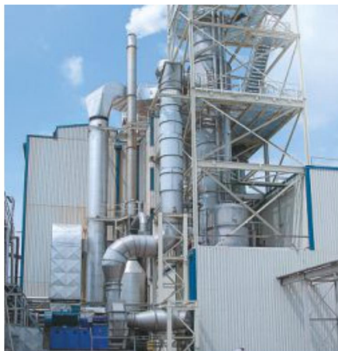
Planta de evaporación de película descendente de 1 efecto calentada por vahos comprimidos mecánicamente para efluentes de almidón de trigo. Caudal de evaporación: 17.000 kg/h
