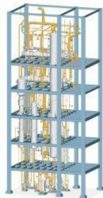
Planta de evaporación de película descendente en contracorriente con unidad de rectificación para refinar aceite de oliva.
