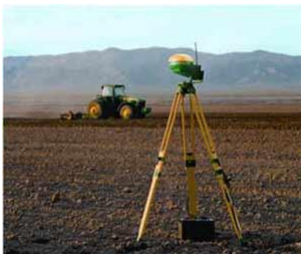
Figura N° 5: Corrección de la señal GPS por RTK
